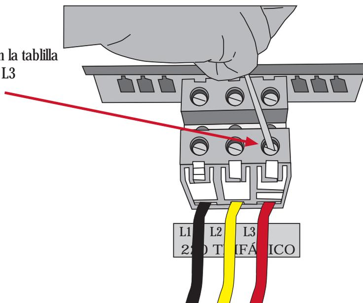
Conecte los cables de los motores en la tablilla de conexiones rotulada como T1-T2-T3 para cada bomba en la plantilla del tablero.
