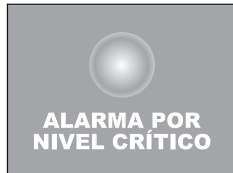
\*Si se activa la alarma por nivel crítico, corrobore que la instalación del flotador se realizo de acuerdo al punto 4, inciso b, Fig.5 y Fig.6 del manual del flotador.
