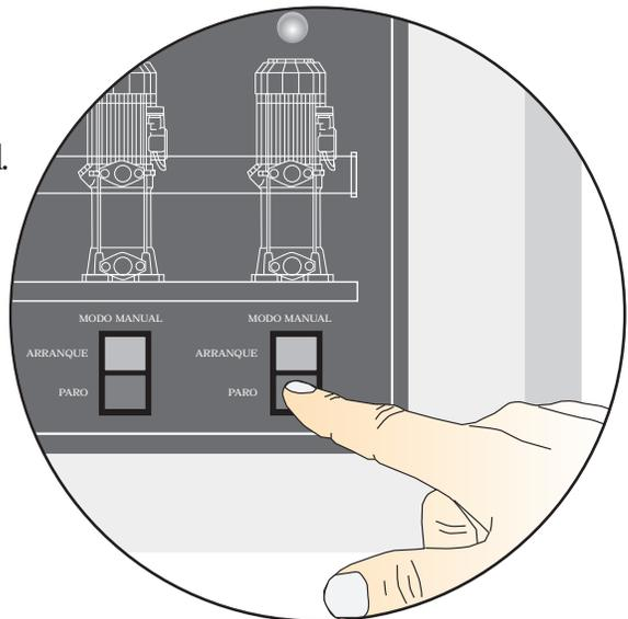
El sentido de giro de los motores se debe de revisar en ambos modos de operación esto por el arreglo de control del tablero. El sentido de giro es muy importante ya que con esto aseguramos una mayor captación de agua debido a la rotación de los impulsores internos.
