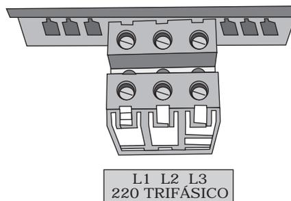
Conecte los cables de Voltaje de la Instalación, en la tablilla de conexiones del tablero rotulada como L1-L2 Y L3
